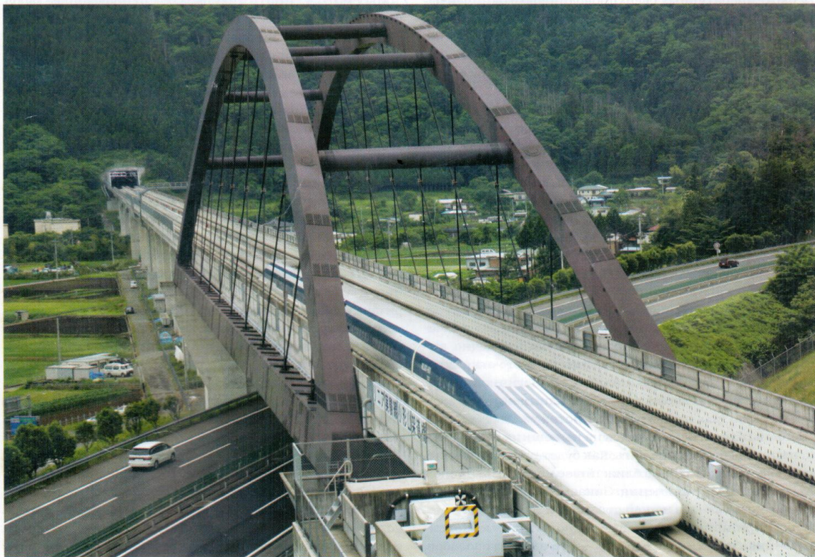
Сверхскоростной (500 км/ч) сверхпроводниковый поезд на магнитной подушке — уже реальность
